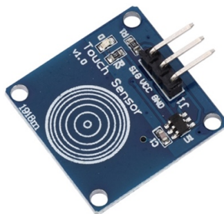
Gambar 2.4 Sensor Sentuh TTP223B
